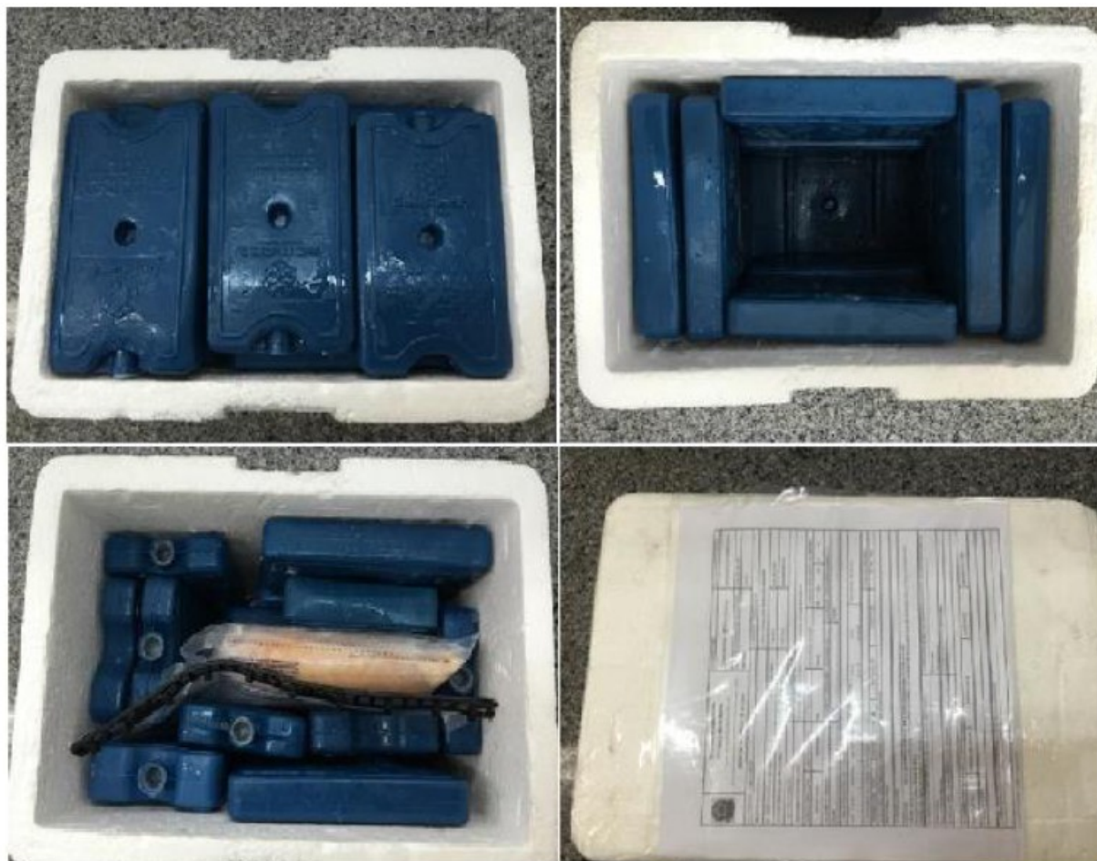
Figura 2 – Acondicionamento da amostra em caixa de isopor e fixação do Termo de colheita de amostra (TCA) na superfície externa da caixa de envio da amostra.
